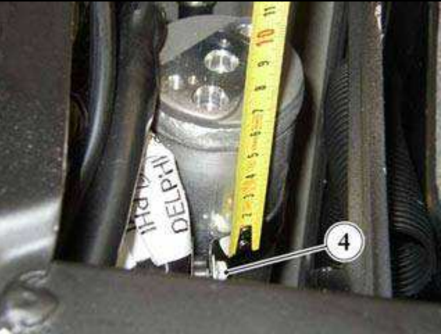
将新的过滤器安装在距离固定架高度为 65 mm 的位置并使用螺钉 (4) 固定。
