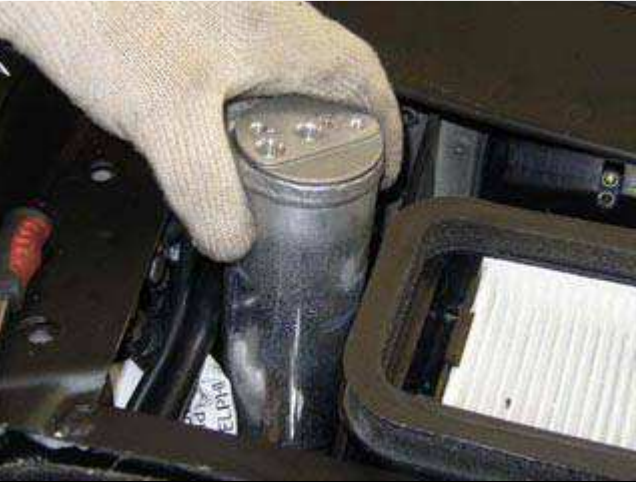
拆卸脱水过滤器。
