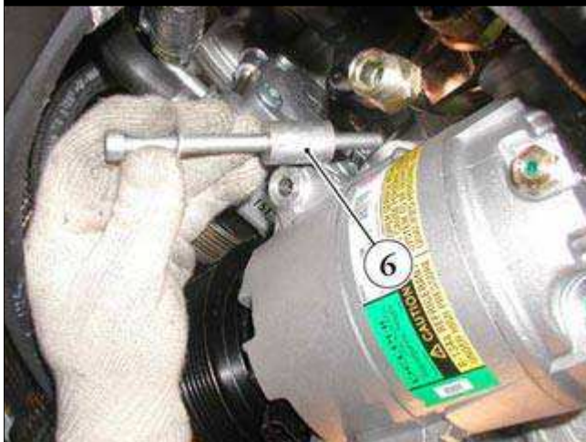
● 放置上部紧固螺钉的垫圈 (6)。
